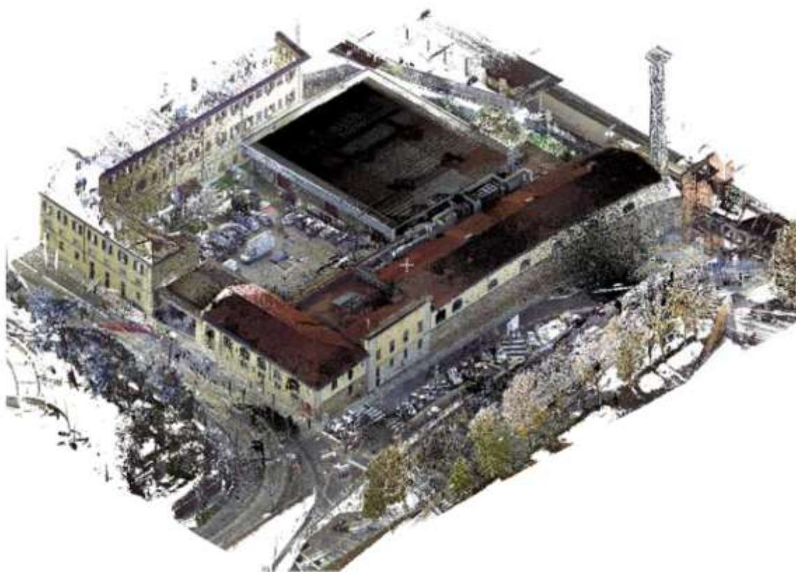
Figura 37 – Immagine ricavata dalla nuvola di punti di rilievo ottenuto con laserscanner
