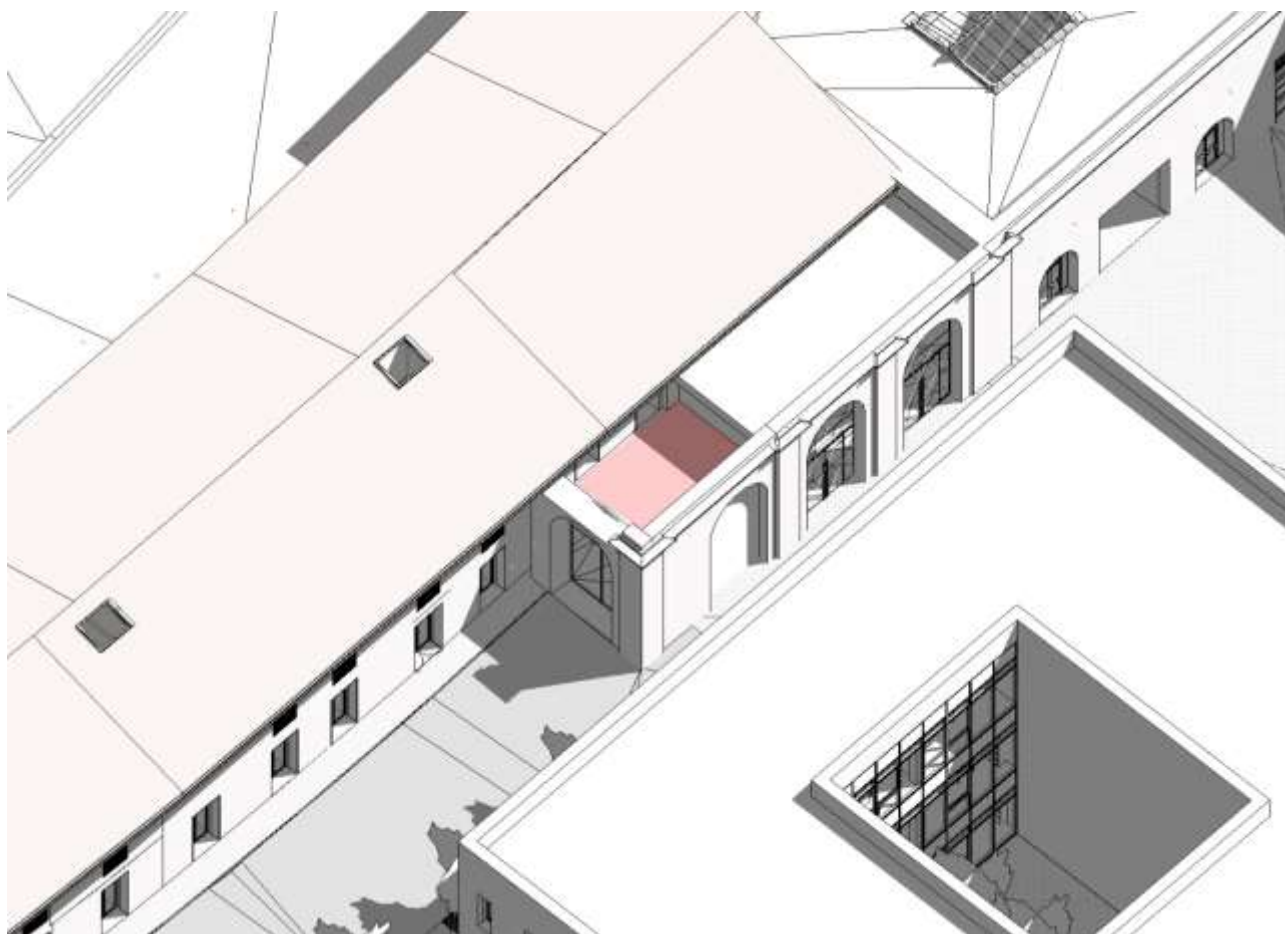
Figura 83 – dettaglio della terrazza a tasca (evidenziata di rosso)
